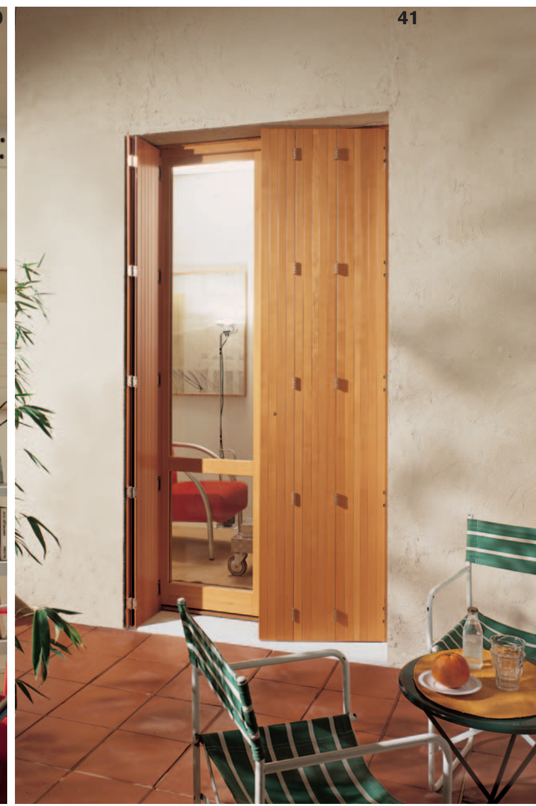
41 Gli scuretti pieghevoli sono disponibili negli spessori di 14 e 19 mm, ogni lato viene diviso in più ante attraverso speciali cerniere che consentono di ripiegarle una sull'altra. In questo modo si può aprire totalmente il serramento esterno accostandolo alla mazzetta del muro.
